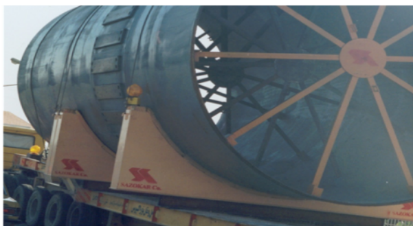
شکل 6-13: نمونه ای از قید گهواره ای زین
