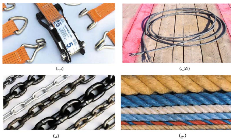
شکل (2-13): تصاویری از بندهای مورد استفاده در مهار بارها
