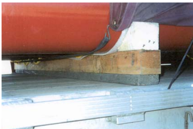
شکل (2-19): نمونه هایی از ضربه گیر چوبی
