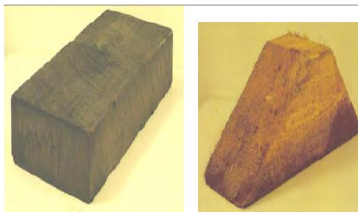
شکل (2-16): نمونه هایی از قید افقی و گوه
