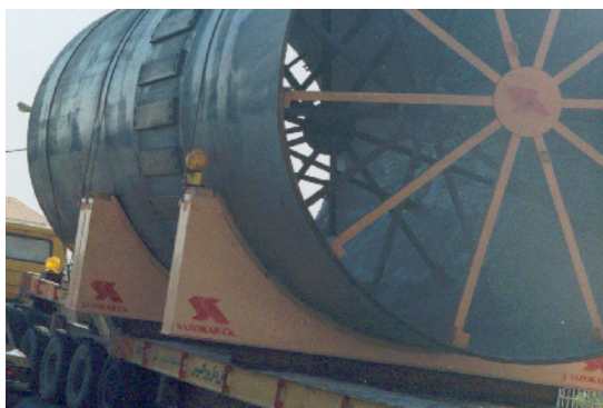
شکل (2-18) : نمونه هایی از قید افقی و گوه
