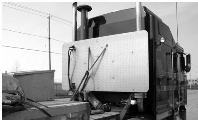
شکل (2-28): نمونه ای از تیغه محافظ در پشت کابین راننده
