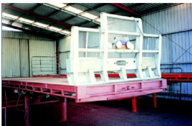
شکل (2-27): نمونه ای از تخته سر در ابتدای بارگیر
