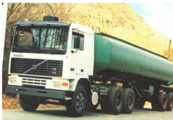
شکل (2-10). مثالی از بارگیرهای مخزن‌دار
