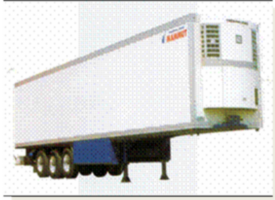
شکل (2-9). مثالی از بارگیر های یخچالدار
